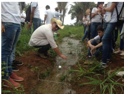
Figura 3. Estudantes cronometrando o tempo que a pequena bola de isopor gastou para realizar o percurso entre uma secção reta e a outra.
